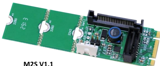
M2S V1.1 (SATA 電源付 M.2-Socket2-B+M-2242SATA アダプタ) x1
